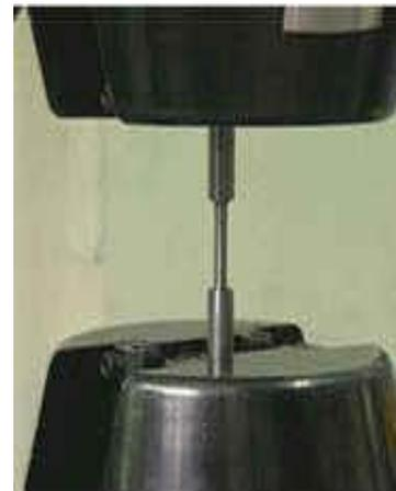
3. Epreuve installée entre les mors de machine de traction.
